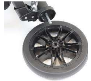
Zdj. 9.5.2 Demontaż koła
